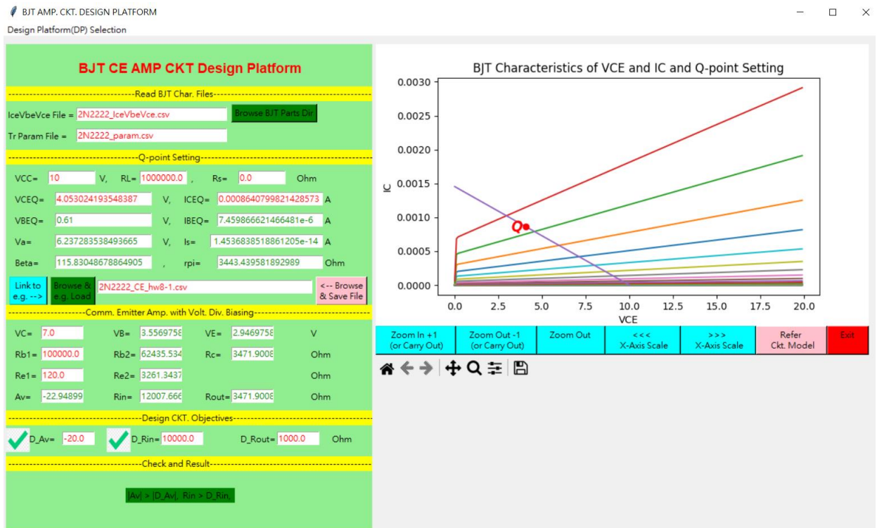
圖 5-2 右半圖顯示該電路 Q-point 設定畫面
