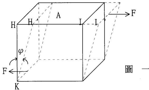
一個立方體受一水平力  $F$  而產生形變，假定底面固定，則其每一層的位移與到底層的距離成正比，是為側向應變，亦稱為切應變。假設圖一頂面的  $H$ 、 $I$  兩點移至  $H'$ 、 $I'$  兩點， $KH$  與  $KH'$  間之夾角  $\varphi$  很小，受力面大小為  $A$  (注意：此面是與  $F$  相切)，則
