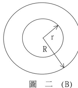
如圖(二)所示，一金屬桿其長為  $L$ ，半徑  $R$ ，上端固定，下方繫一圓盤，將其扭轉  $\theta$  角轉動，使得原來  $AB$  垂直線扭轉成  $AC$ 。 $AB$  與  $AC$  所夾之角為  $\varphi$ ， $BC$  所張的角為  $\theta$ ，則  $L\varphi = \text{弧長 } BC = R\theta$ 。因為對稱，所以施力與形變在  $r$  至  $r + dr$  的圓環上應均勻一致。(參考圖二(b))
