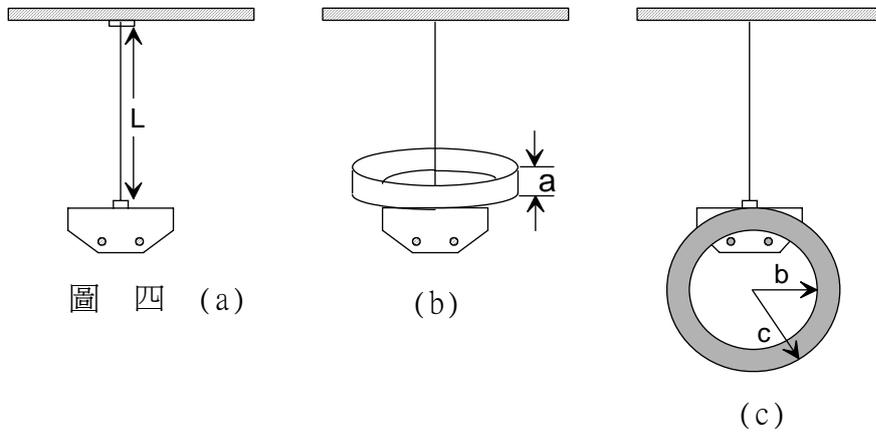
如圖四(a)所示，有一鋼線懸掛一重  $W$  的中空扭轉盤，其轉動慣量為  $I_0$ ，其上放置金屬環的方式有二，如圖四(b)、圖四(c)所示，而其轉動慣量分別為  $I_1$  及  $I_2$ 。由式(4)得知
